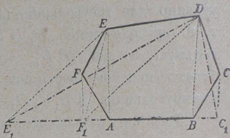
Спрямленіе ломаной линіи. Система линій  $ABCD$  (фиг. 9) должна быть замѣнена прямою линіею, проходящею черезъ точки  $A$  и  $B_1$ ,
