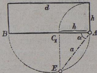
въ одну и ту-же сторону и описывая на  $d$ , какъ діаметрѣ, полуокружность; тогда, по чертежу, получимъ  $AE = a$ . (Такъ какъ  $\cos \alpha = AC_1 : AE = h : a$ , а также  $\cos \alpha = AE : AB = a : d$ , то  $a^2 = d \cdot h$ ).
