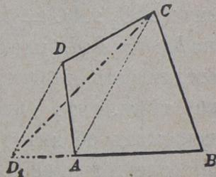
Превращеніе прямоугольника  $ABCD$  (фиг. 5) въ таковой-же съ основаніемъ  $d_1 = AB_1$  производится совершенно подобно тому, какъ это было указано для треугольника (фиг. 1), т. е. проводя линію  $B_1D$  и параллельную въ ней  $BD_1$ ; тогда  $D_1$  будетъ исковою вершиною новаго прямоугольника  $AB_1C_1D_1$ .
