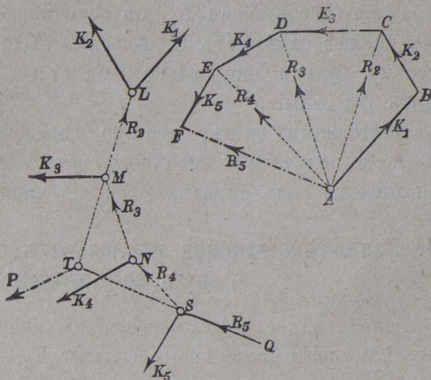
Подобнымъ-же образомъ, проводя черезъ точку  $N$  параллель  $AE$  до пересѣченія, въ точкѣ  $S$ , со слѣдующею силою  $K_5$ , и, наконецъ, черезъ  $S$ , линію  $SQ \parallel AF$ , найдемъ  $QS$ , т. е. направленіе равнодѣйствующей  $R$  всѣхъ 5-ти данныхъ силъ.
