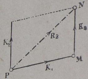
Если требуется сложить нѣсколько силъ, проходящихъ черезъ точку  $P$ , напр.  $K_1, K_2, K_3, K_4$  (фиг. 18), то цѣлесообразнѣе будетъ произвести находженіе равнодѣйствующей  $R$  на отдѣльномъ чертежѣ (фиг. 18 а). Для этого наносятъ, прежде всего, отъ точки  $A$  силу  $K_1 = AB$ , и, полагая  $K_2 = BC$ , находятъ равнодѣй-
