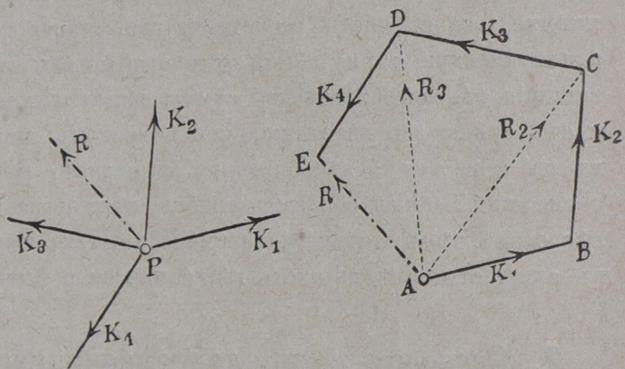
ствующую этихъ двухъ силъ, равную  $R_2 = AC$ . Съ этой силой, вполне замѣняющей собою  $K_1$  и  $K_2$ , складываютъ, подобнымъ-же образомъ, силу  $K_3$ , присоединяя ее въ видѣ отрезка  $DE$ , и получаютъ, наконецъ, равнодѣйствующую  $AE$  всѣхъ данныхъ силъ безъ исключенія. Очевидно, что для нахождения точки  $A$
