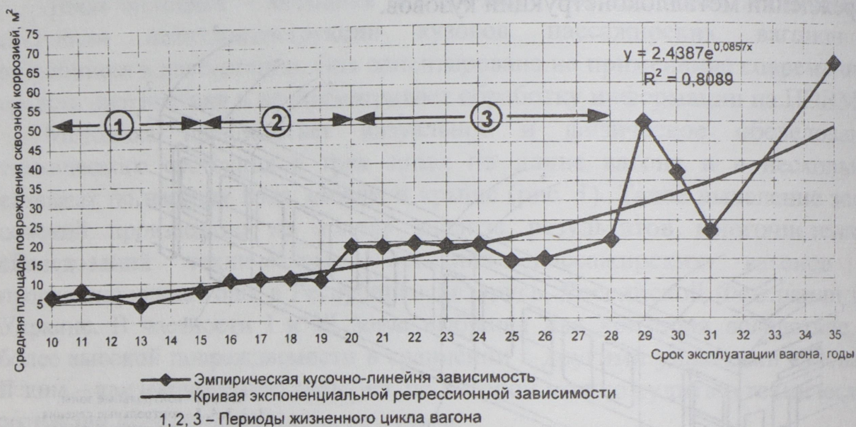
Рис. 2. Зависимость средней площади повреждения кузовов сквозной коррозией от срока эксплуатации вагона
