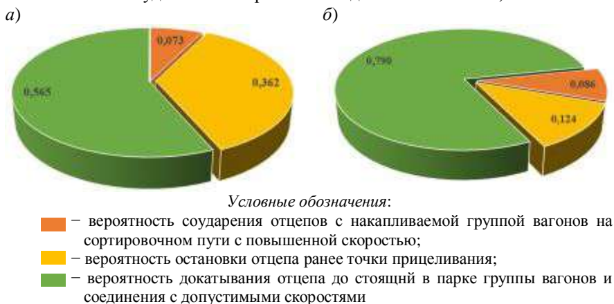
Рисунок 2 – Распределение показателей процесса заполнения сортировочного пути с нормативным продольным профилем (условия благоприятные, тяжелая весовая категория вагонов): существующие (а) и «новые» (б) значения w_0
