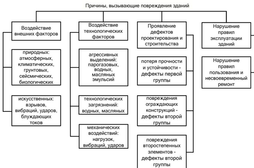
Рисунок 1.1 – Классификация причин повреждений зданий в процессе эксплуатации
