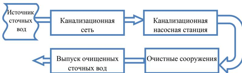
Рисунок 5.1 – Принципиальная схема системы водоотведения
