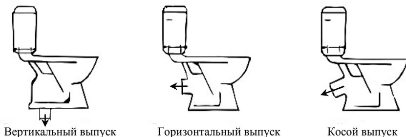
Рисунок 5.8 – Разновидности выводов унитазов
