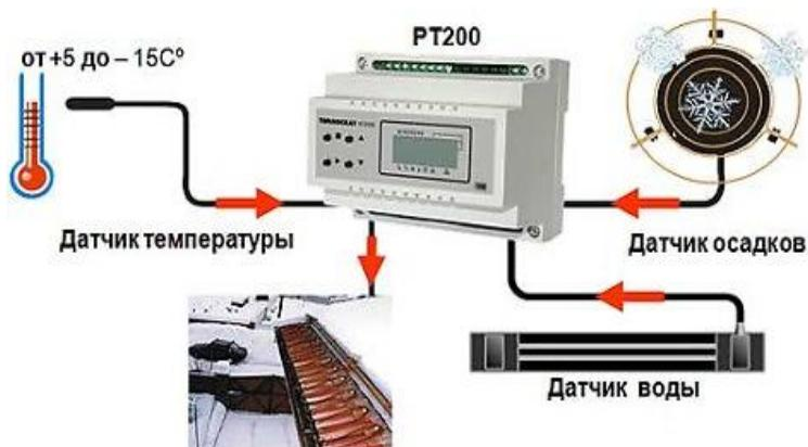
Рисунок 6.13 – Автоматическая система обогрева крыши
