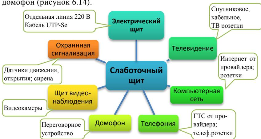
Рисунок 6.14 – Архитектура бытовой слаботочной системы
