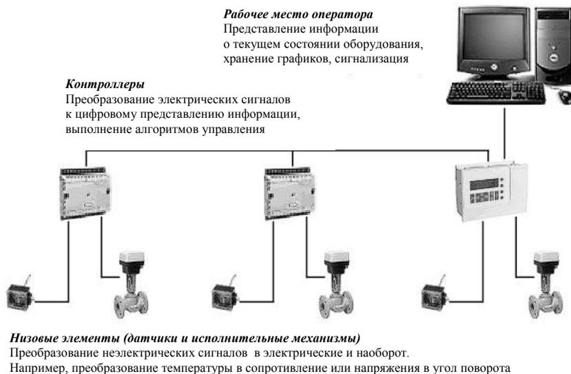
Рисунок 1.2 – Система диспетчеризации и управления
