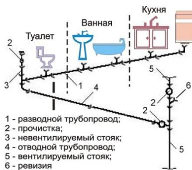
Рисунок 5.3 – Раструбные трубы ревизии из полипропилена (а) и схема установки ревизии и прочистки (б)
