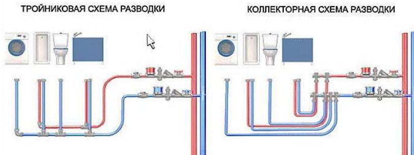
Рисунок 4.5 – Схема разводки труб водоснабжения
