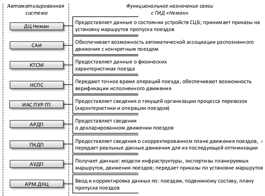
Рисунок 1 – Характеристика функционального взаимодействия ГИД «Неман» с внешними автоматизированными системами
