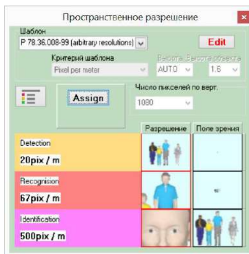
Рисунок 7 – Окно пространственного разрешения для камеры ActiveCam AC-D2053ZIR3
