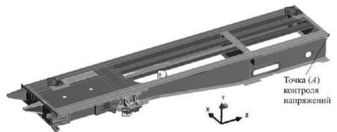
Рисунок 12 – Расчетная модель (1/4 вагона)
