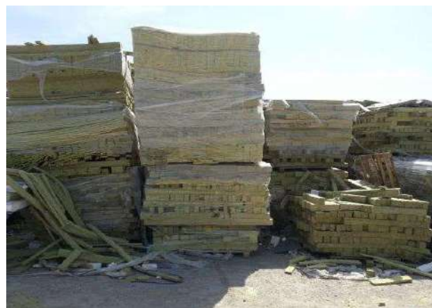
Рисунок 3 – Некачественный выбор сырья для производства сэндвич-панелей
