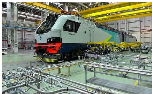
Рисунок 7 – Стенд диагностики электровоза при приёме его в эксплуатацию
