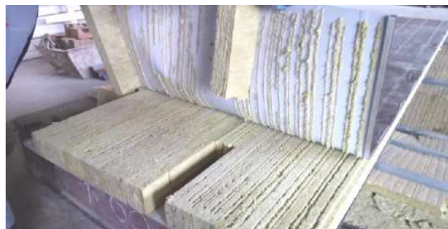
Рисунок 2 – Разрушение конструкции панели из-за неправильно выполненной операции склейки
