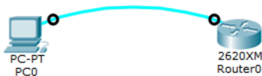
Рисунок 10 – Подключение к консольному порту
