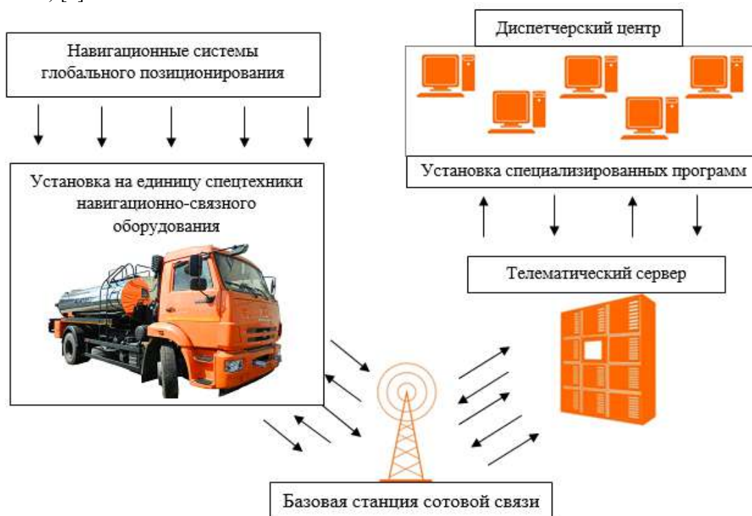
Рисунок 1 – Система работы автоматизированной системы мониторинга спецтехники
