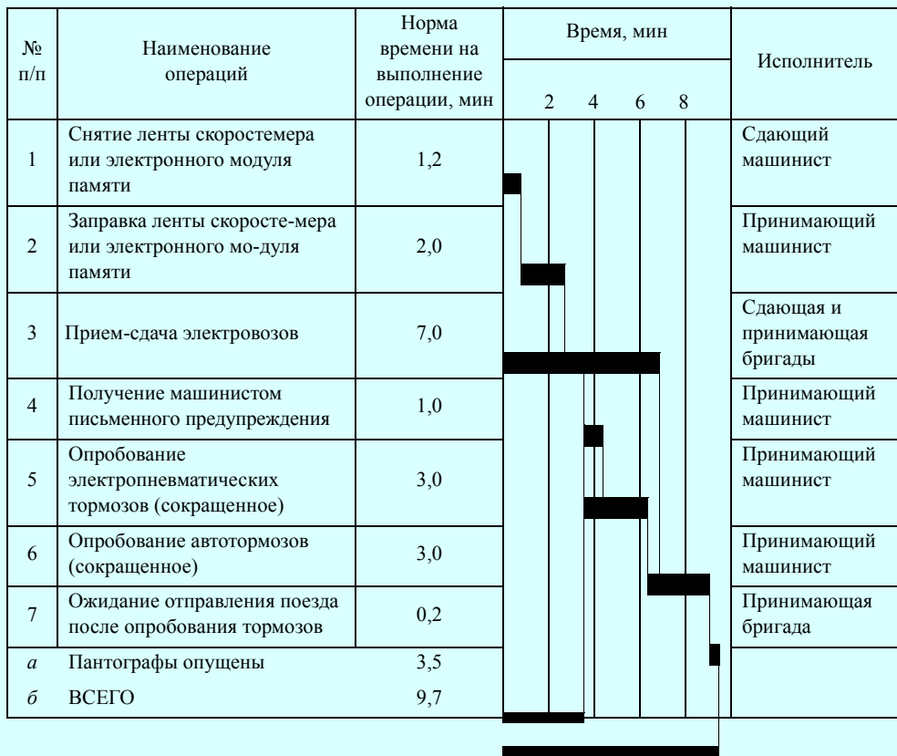
Рис. 4.11. Технологический график выполнения операций при смене локомотивных бригад на односекционном пассажирском электровозе
