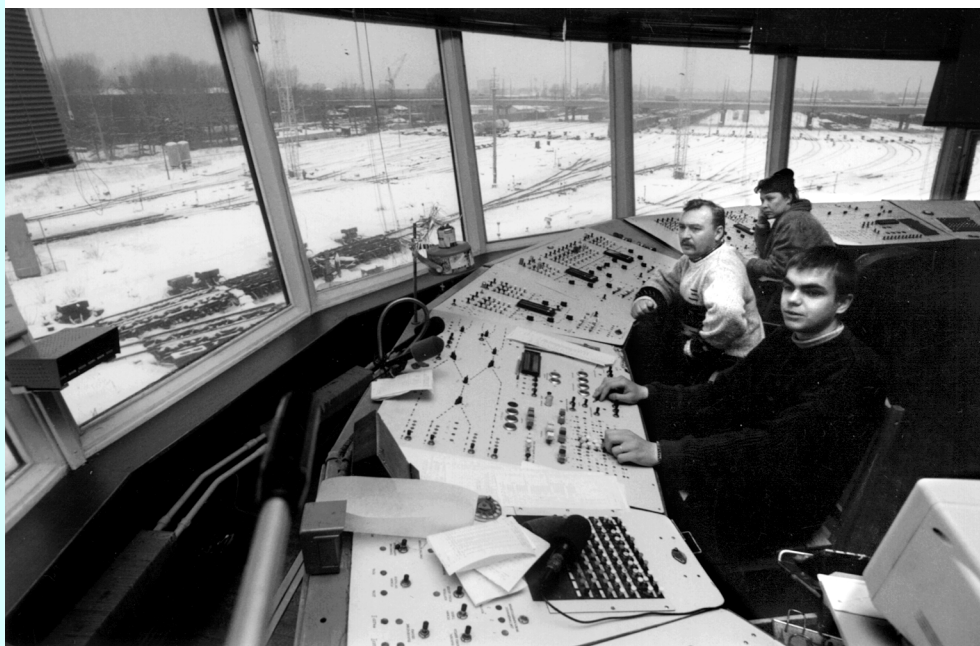
Рис. 2.24. Пост управления автоматизированной сортировочной горкой
