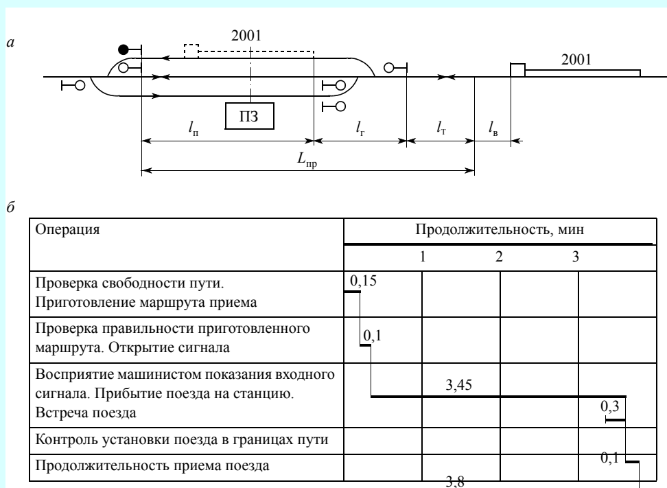
Рис. 2.14. Схема приема поезда на станцию (а) и график выполнения технологических операций (б)
