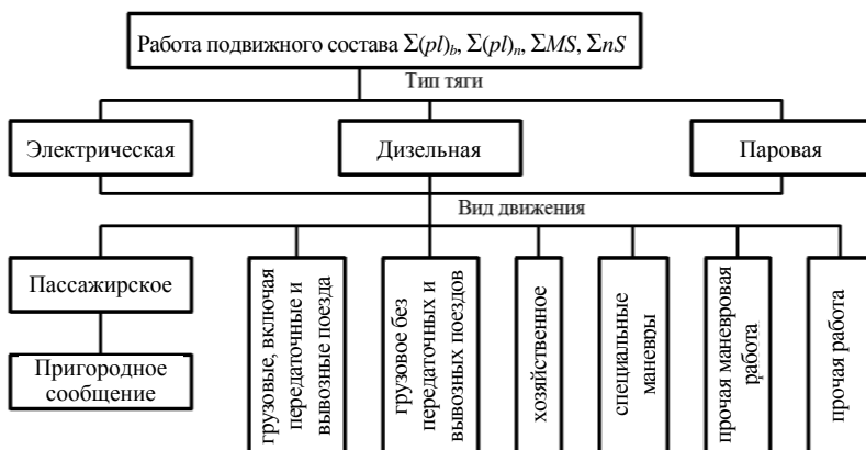
Рисунок 2.8 – Схема группировки работы подвижного состава по типу тяги и виду движения
