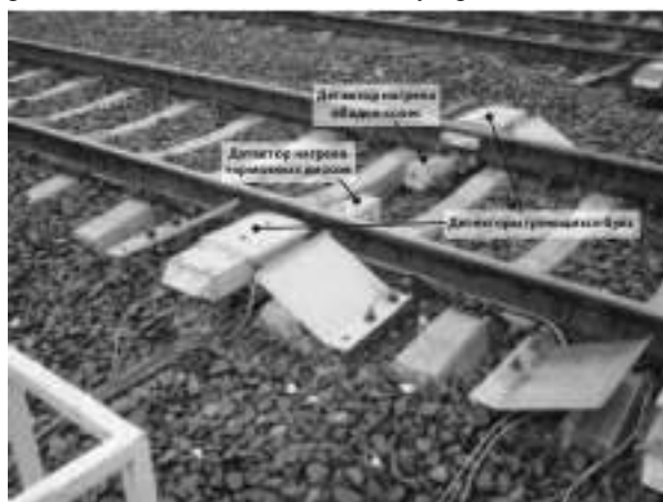
Рисунок 5 – Комбинированный детектор: размещение датчиков контроля температуры греющихся букс, обода колеса и тормозных дисков
