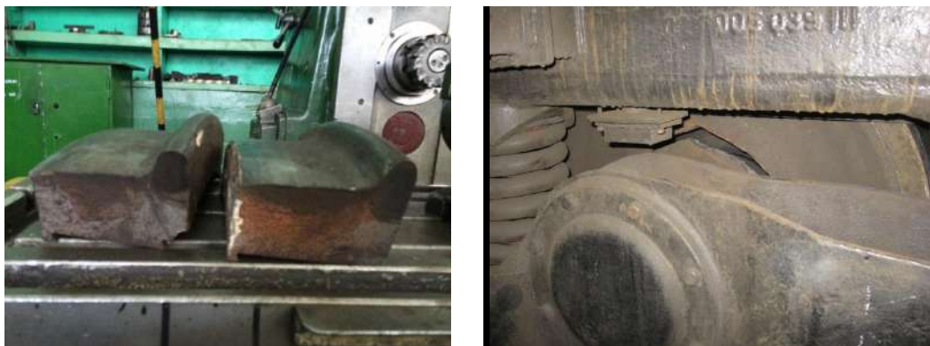
Рисунок 1 – Разрушение бандажа и колесного центра колеса
