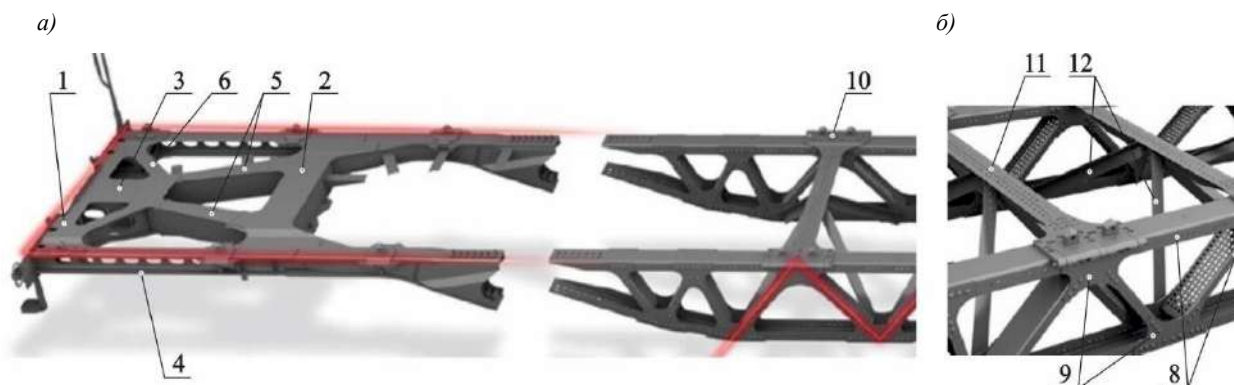
Рисунок 1 – Рама платформы проекта «5L Next»: а – концевая сварная и средняя части; б – фрагмент средней части с поперечными балками рамы
