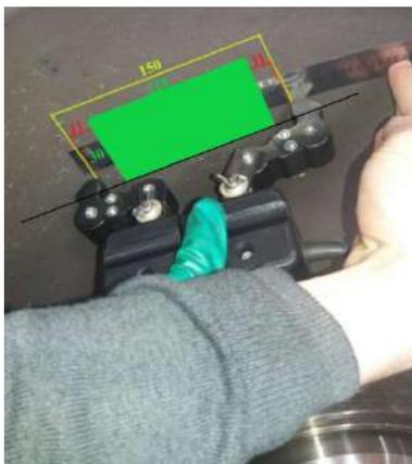
Рисунок 3 – Зона эффективной намагниченности участка колеса с левой стороны электромагнита при расстоянии между полюсами 150 мм (прямоугольник зеленого цвета)
