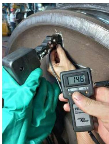
Рисунок 2 – Определение зоны ДН на цельнокатаном колесе практическим путём (сталь 2):
