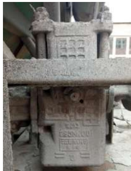
Рисунок 1 – Состояние деталей вагонов, поступающих в ремонт: а – тормозной цилиндр 188-Б полувагона; б – рабочая камера 295М.001 полувагона; в – рабочая камера 295М.001 цементовоза; г – главная часть 270.023 цементовоза
