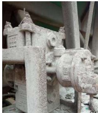
Рисунок 1 – Состояние деталей вагонов, поступающих в ремонт: а – тормозной цилиндр 188-Б полувагона; б – рабочая камера 295М.001 полувагона; в – рабочая камера 295М.001 цементовоза; г – главная часть 270.023 цементовоза
