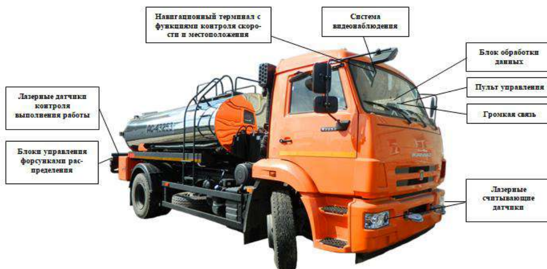
Рисунок 2 – Пример реализации автоматизированной системы мониторинга (на примере автогудронатора)
