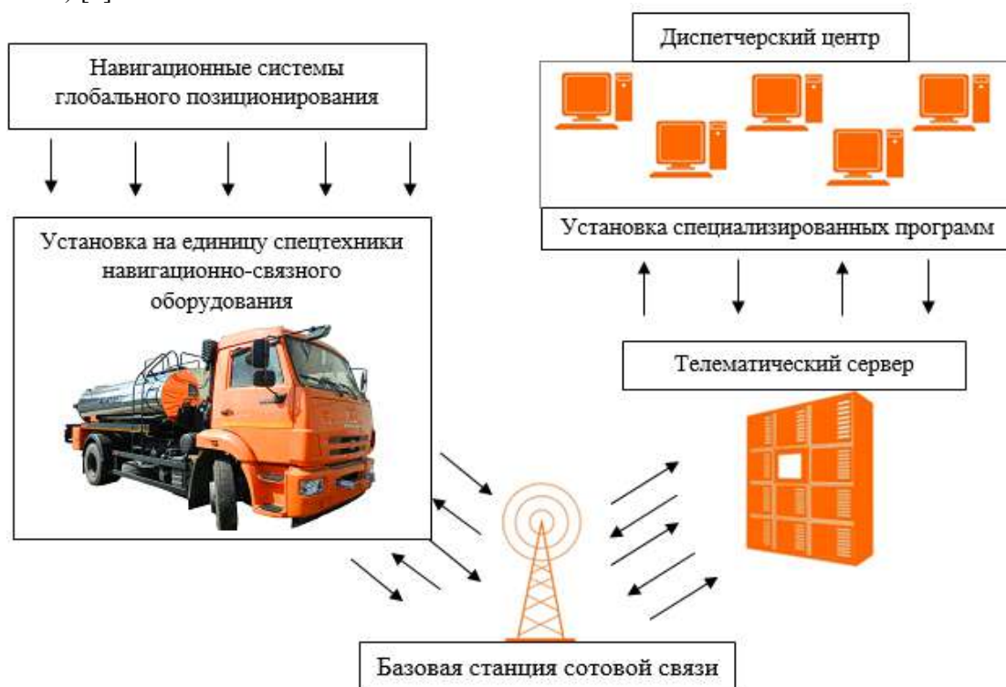
Рисунок 1 – Система работы автоматизированной системы мониторинга спецтехники
