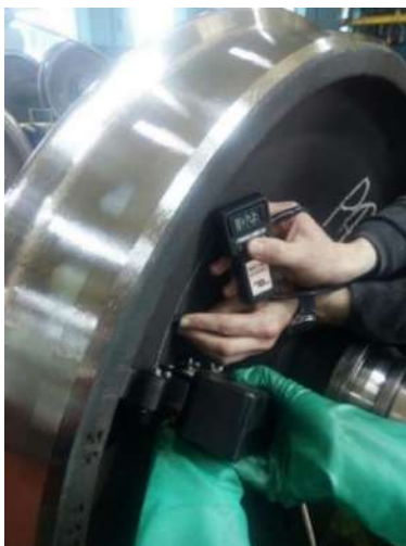
Рисунок 2 – Определение зоны ДН на цельнокатаном колесе практическим путём (сталь 2): a – определение ширины b зоны ДН; b – определение тангенциальной составляющей H_t на расстоянии 5 мм от полюсного наконечника; v – определение нормальной составляющей H_n на расстоянии 5 мм от полюсного наконечника
