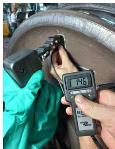
Рисунок 2 – Определение зоны ДН на цельнокатаном колесе практическим путём (сталь 2): a – определение ширины b зоны ДН; b – определение тангенциальной составляющей H_t на расстоянии 5 мм от полюсного наконечника; v – определение нормальной составляющей H_n на расстоянии 5 мм от полюсного наконечника
