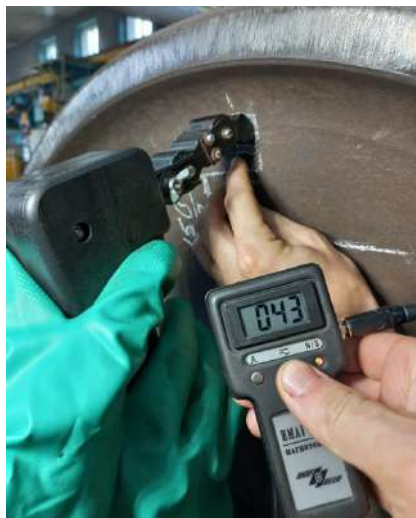
Рисунок 2 – Определение зоны ДН на цельнокатаном колесе практическим путём (сталь 2): a – определение ширины b зоны ДН; b – определение тангенциальной составляющей H_t на расстоянии 5 мм от полюсного наконечника; v – определение нормальной составляющей H_n на расстоянии 5 мм от полюсного наконечника
