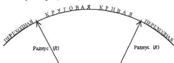
Рисунок 2 – Схема закругления с переходными кривыми
