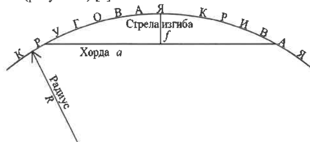
Рисунок 1 – Универсальная схема использования способа хорд
