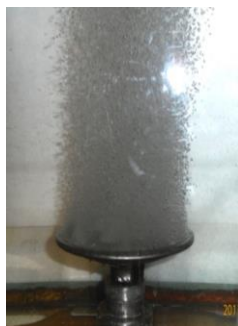
Рисунок 1 – Генерация пузырьков воздуха в воде трубчатым (а) и дисковым (б) пористыми аэраторами, спеченными из губчатого порошка титана марки ТПП-5
