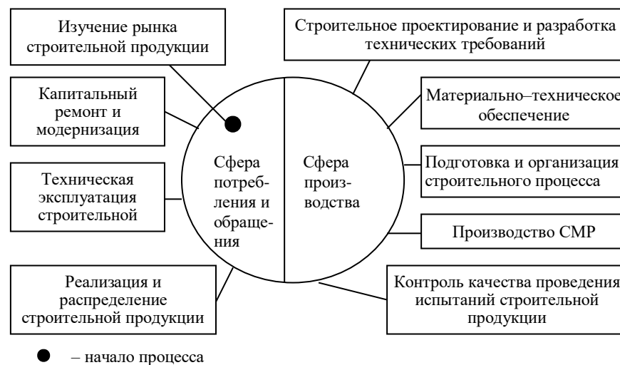
Рисунок 6.1 – «Петля качества» строительной продукции
