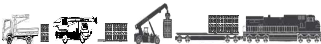
Рисунок 6 – Технологическая схема консолидации среднетоннажных модулей на контейнере-платформе с помощью автомобиля-самогрузчика или автокрана и погрузка-выгрузка среднетоннажных модулей 20-ти футовым комплектом с помощью ричстакера
