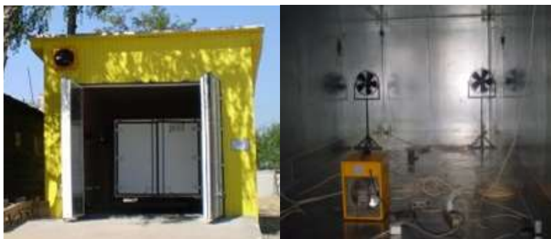
Рисунок 1 – Бокс для проведения теплотехнических испытаний
