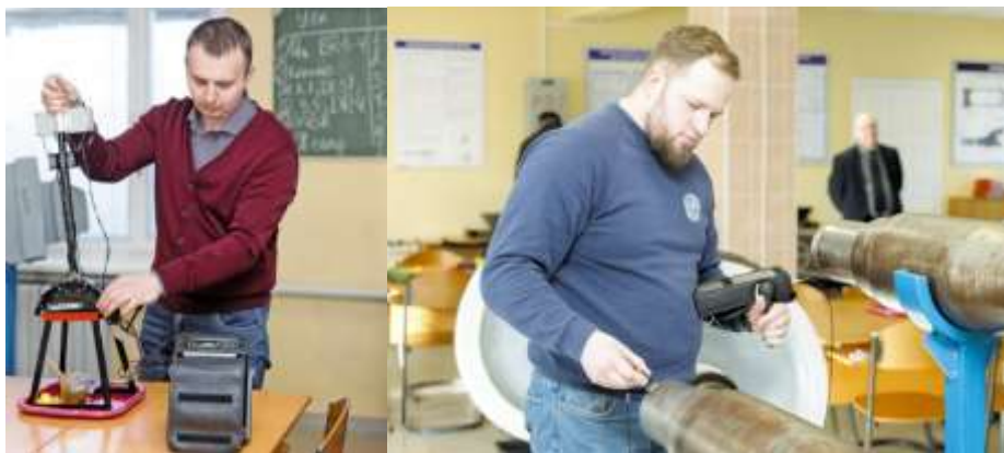
Рис. 3. Дефектоскописты ЛНК выполняют практические испытания, которые включают в себя настройку оборудования, нахождение дефектов и оформление протокола контроля
