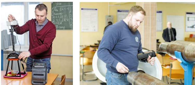
Рисунок 3 – Дефектоскописты ЛНК выполняют практические испытания, которые включают в себя настройку оборудования, нахождение дефектов и оформление протокола контроля
