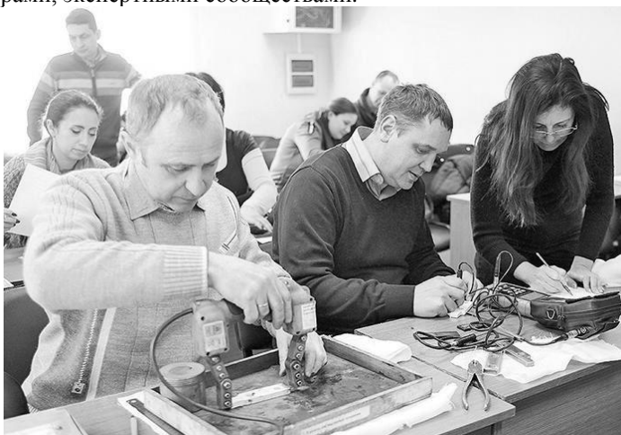
Рисунок 1 – На переднем плане руководители ЛНК Белорусской железной дороги выполняют магнитопорошковый и вихретоковый контроль выданных образцов
