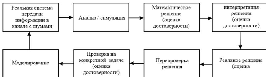
Рисунок 2 – Структурная схема математического моделирования ДСК
