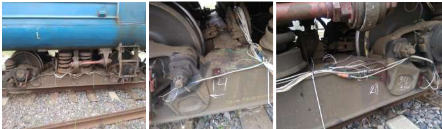
Рисунок 3 – Установленные на раме тележки датчики деформаций
