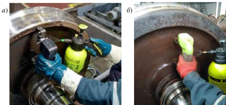
Рисунок 1 – Магнитопорошковый контроль цельнокатаного колеса («ручной» способ): а – контроль приободной части и диска колеса при помощи электромагнита МЭД-120; б – контроль диска колеса при помощи электромагнита Magnaflux Y1
