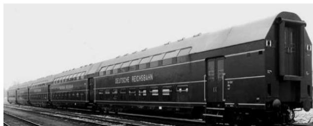
Рисунок 5 – Двухэтажные пятивагонные пассажирские поезда сочлененного типа
