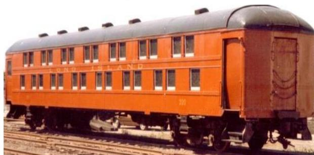
Рисунок 4 – Двухэтажный пассажирский вагон с шахматным расположением сидений
