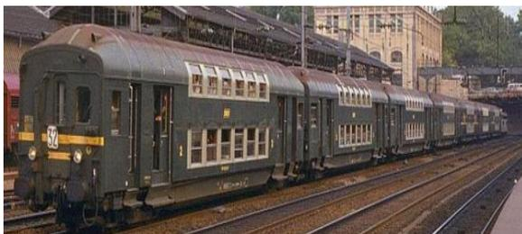
Рисунок 1 – Двухэтажные пассажирские вагоны французского производства образца 1933 г.
