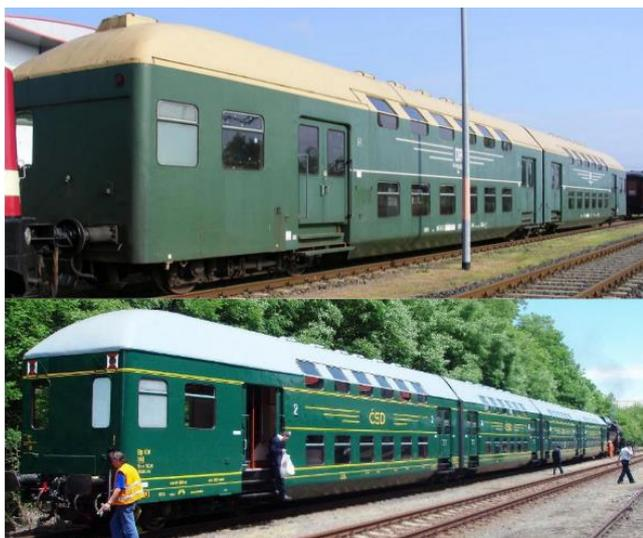
Рисунок 3 – Двухэтажные поезда с двух- и четырехвагонными секциями
