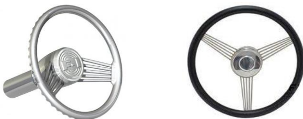
Рисунок 3.9 – Рулевое колесо типа «Банджо»
