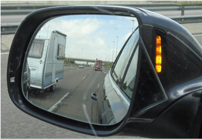
Рисунок 2.129 – Сигнальные лампы, встроенные в зеркало заднего вида
