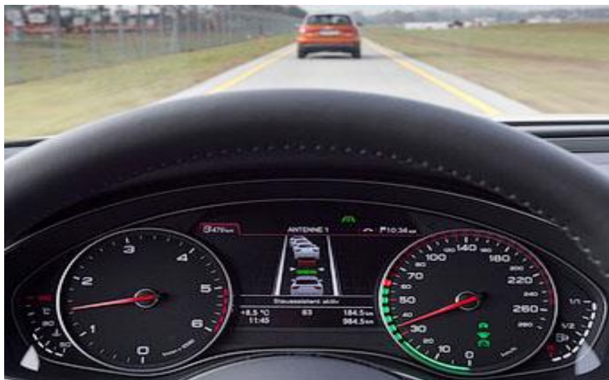
Рисунок 6.6 – Работа системы Traffic Jam Assistant. Фото Audi
