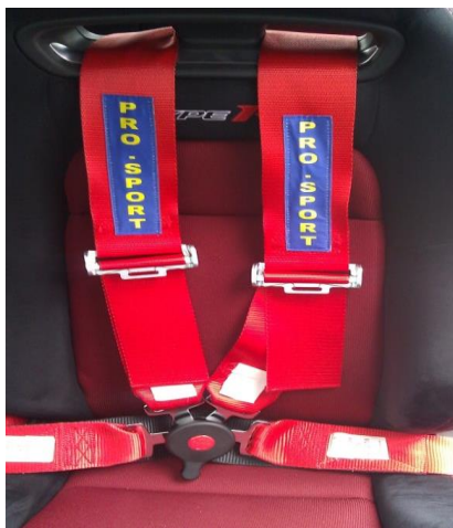
Рисунок 3.16 – Четырехточечный ремень безопасности
