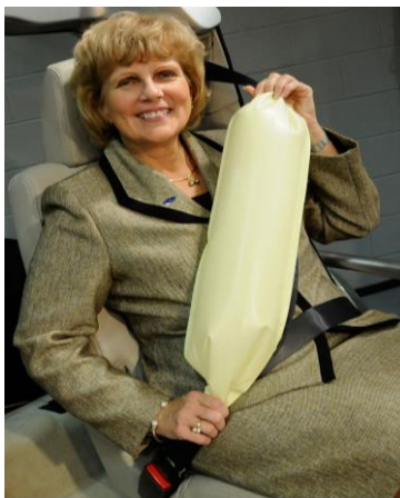
Рисунок 3.18 – Надувной ремень безопасности
