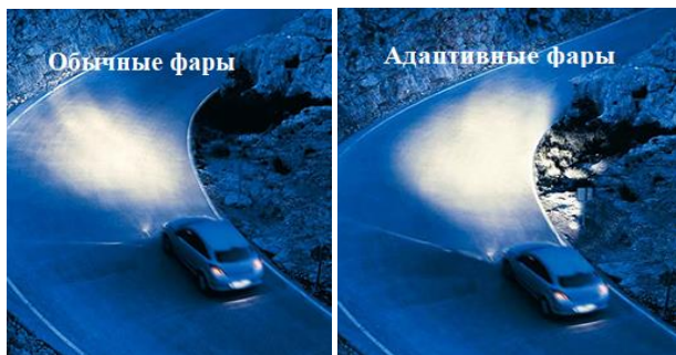
Рисунок 2.50 – Работа системы адаптивного освещения
