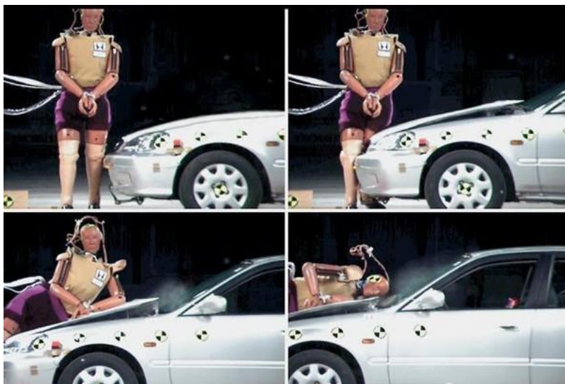
Рисунок 3.37 – Подъем капота при наезде на пешехода
