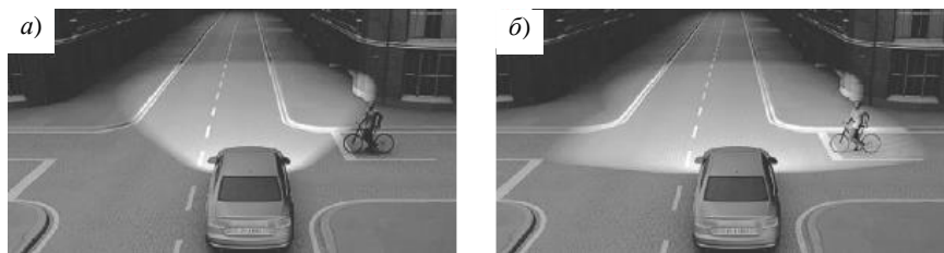
Рисунок 2.53 – Освещение дороги при наличии перекрестка без дополнительной подсветки (а) и с дополнительной подсветкой (б)
