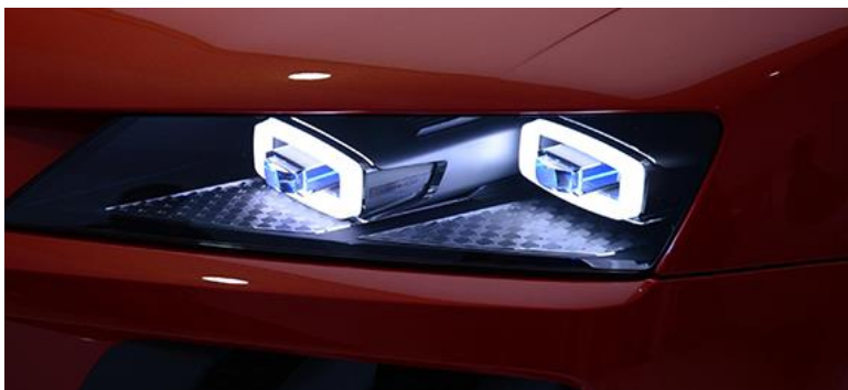
Рисунок 2.47 – Лазерная фара автомобиля Audi
