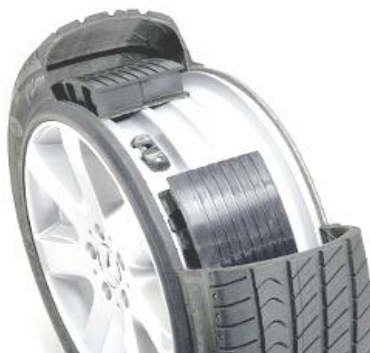
Рисунок 2.106 – Шина RunFlat с поддерживающим кольцом
