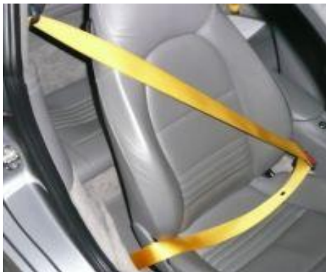
Рисунок 3.15 – Трехточечный ремень безопасности
