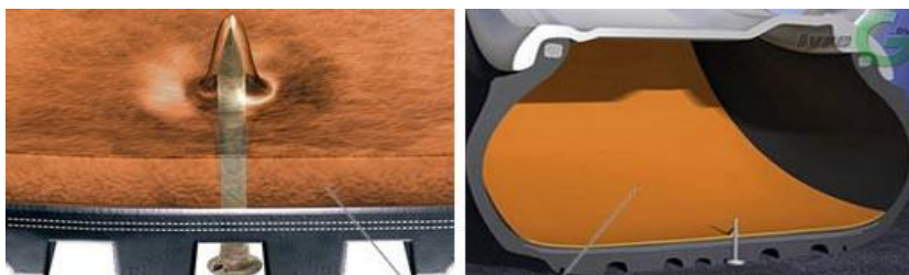
Герметик в полости шины
