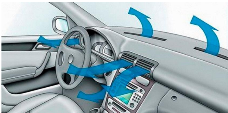
Рисунок 2.91 – Организация потоков воздуха на рабочем месте водителя легкового автомобиля
