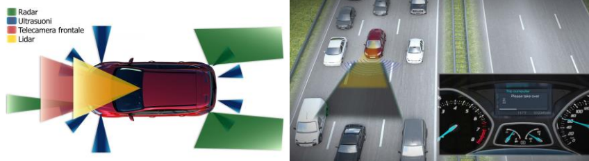
Рисунок 6.7 – Система Traffic Jam Assist – система помощи при движении в пробках
