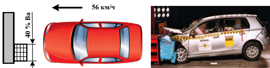
Рисунок 3.5 – Испытание методом фронтального столкновения с деформируемым препятствием
