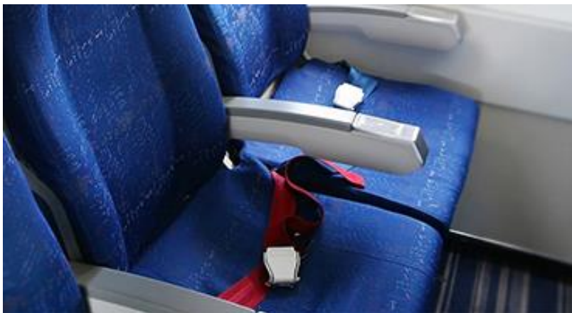
Рисунок 3.14 – Двухточечный ремень безопасности
