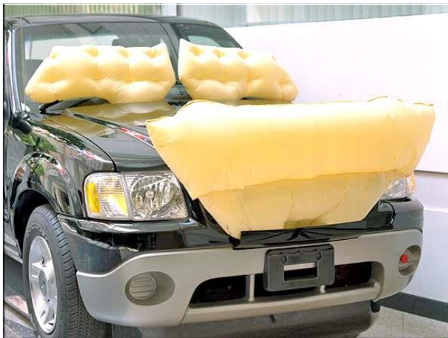
Рисунок 3.38 – Пневматические подушки для защиты пешеходов
