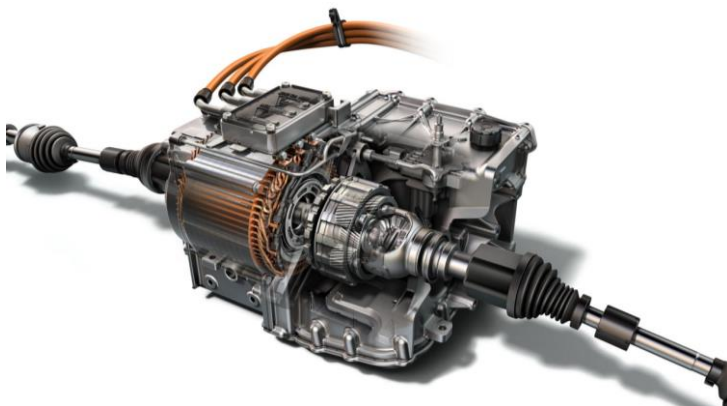
Рисунок 5.4 – Силовая установка электромобиля
