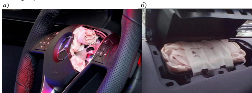
Рисунок 3.26 – Подушка безопасности в ступице рулевого колеса (а), в нише передней панели автомобиля (б)
