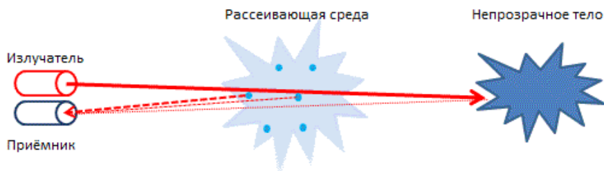
Рисунок 6.2 – Принцип действия лидара
