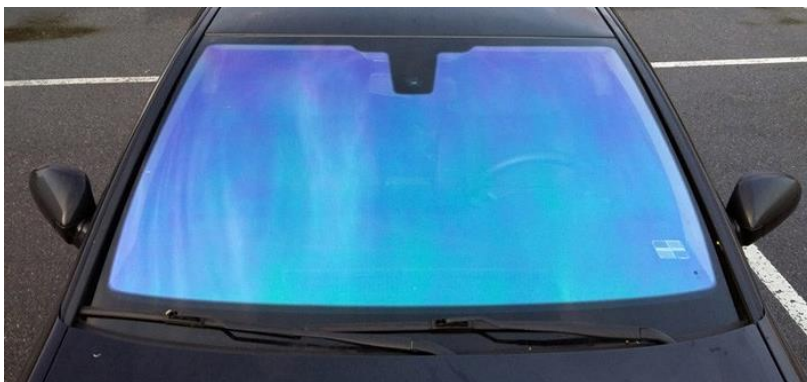
Рисунок 3.29 – Ветровое атермальное стекло автомобиля
