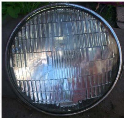
Рисунок 2.39 – Рассеиватель фары с американской системой светораспределения
