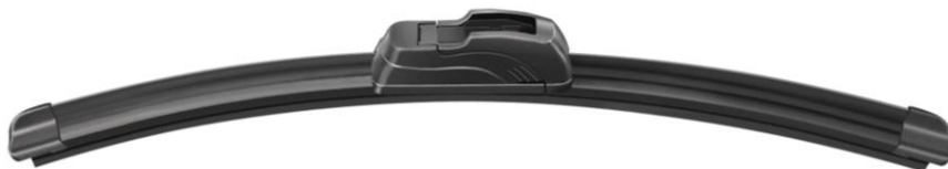
Рисунок 2.69 – Щетка стеклоочистителя с бескаркасным держателем
