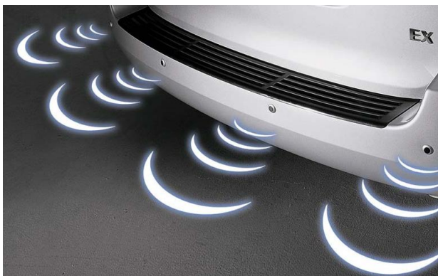
Рисунок 2.135 – Расположение датчиков в заднем бампере автомобиля
