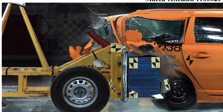
Рисунок 3.6 – Испытание методом удара сзади
