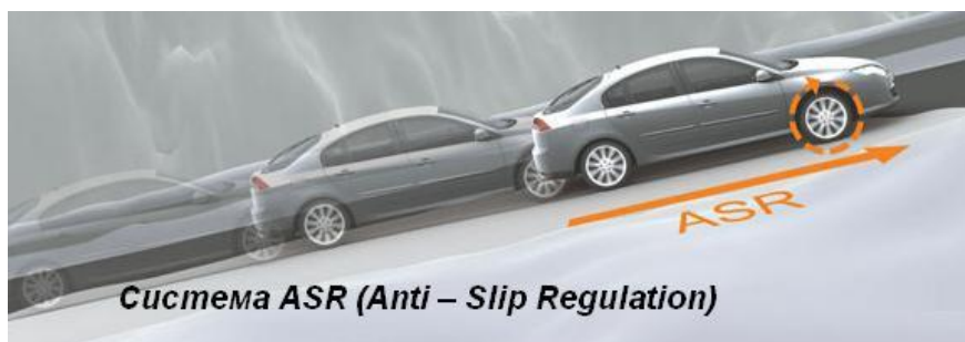
Рисунок 2.115 – Принцип работы антипробуксовочной системы
