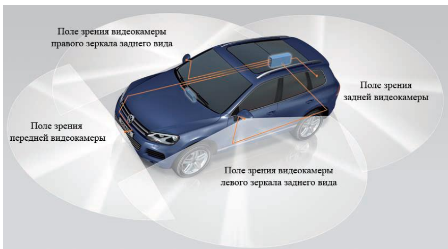
Рисунок 2.73 – Зона контроля окружающего пространства с помощью четырех видеокамер
