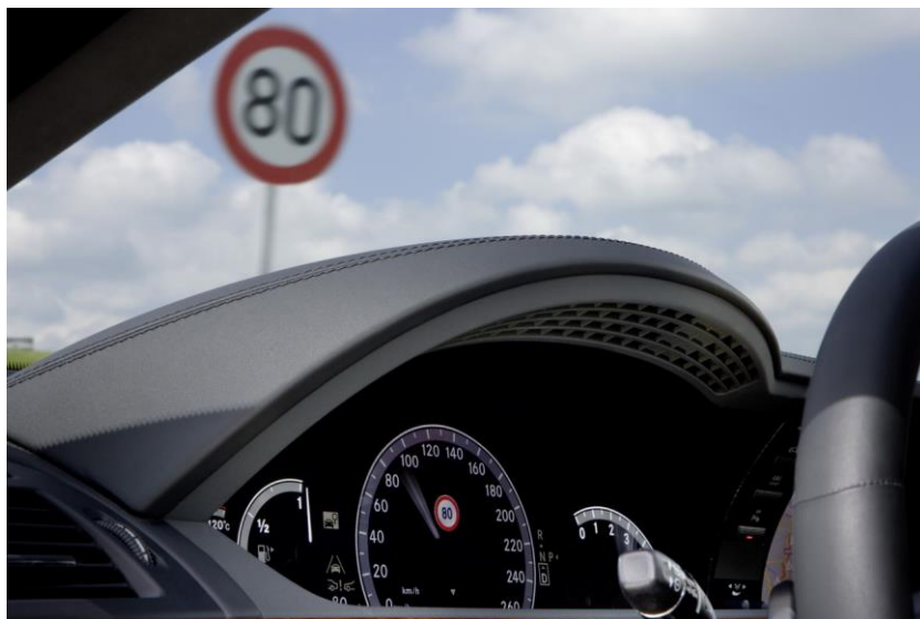
Рисунок 2.76 – Изображение в виде знака на приборной панели
