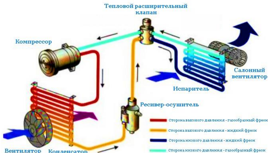
Рисунок 2.94 – Схема работы парокомпрессионного воздухоохлаждителя
