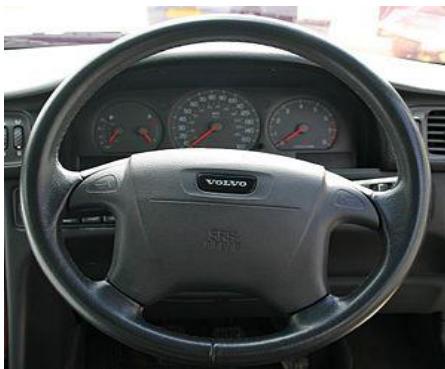
Рисунок 3.11 – Рулевое колесо автомобиля «Volvo» с увеличенной ступицей
