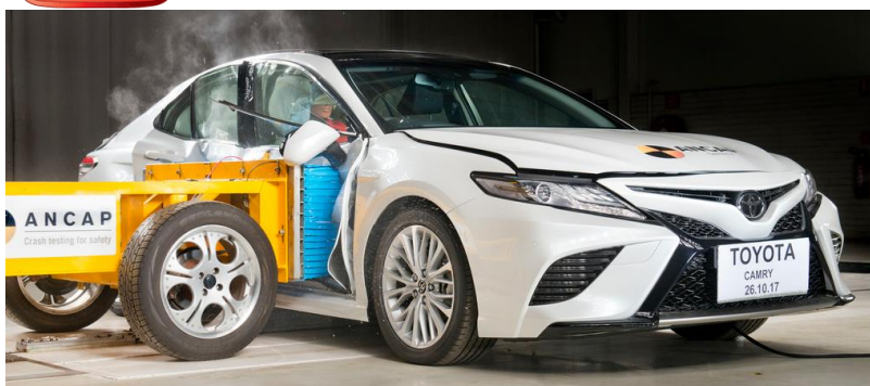
Рисунок 3.7 – Испытание на боковой удар
