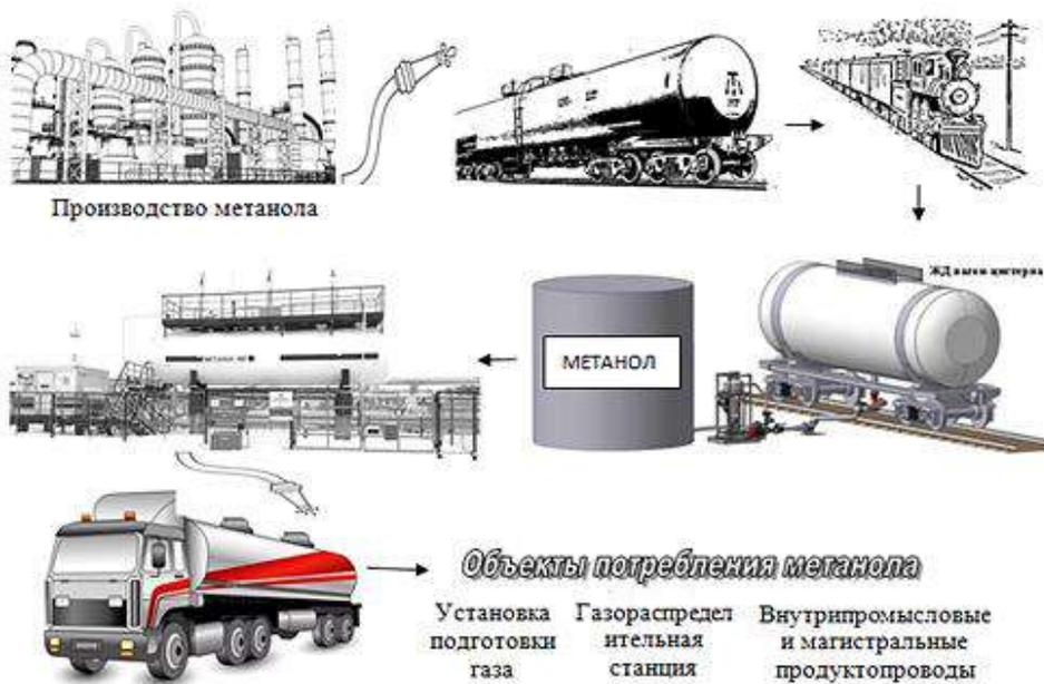
Рисунок 1 – Транспортная схема доставки метанола до объектов потребления
