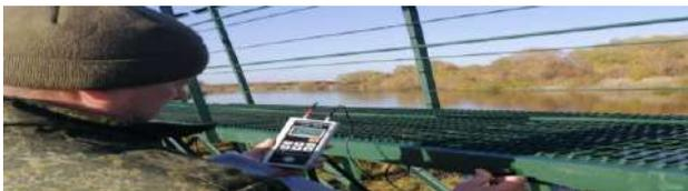
Рисунок 1 – Измерение толщины металла
