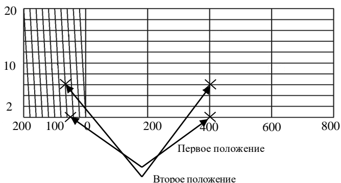
Рисунок 8 – Измерение расстояний по карте с помощью поперечного масштаба
