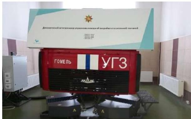
Рисунок 1 – Динамический автотренажер управления пожарной аварийно-спасательной техникой
