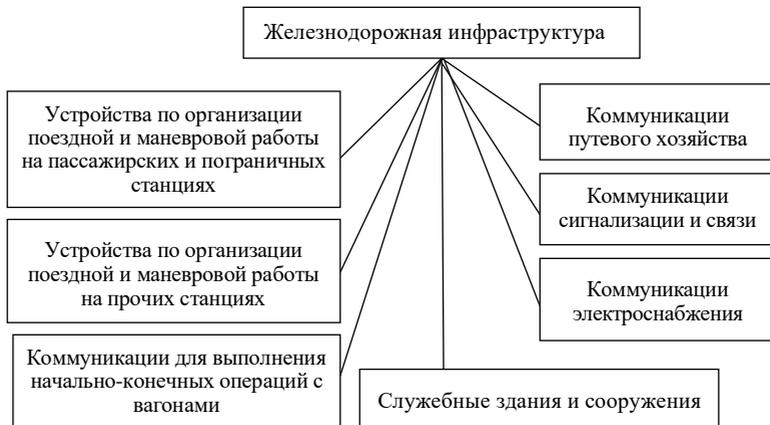
Рисунок 3.2 – Технологическая схема инфраструктуры железнодорожного транспорта
