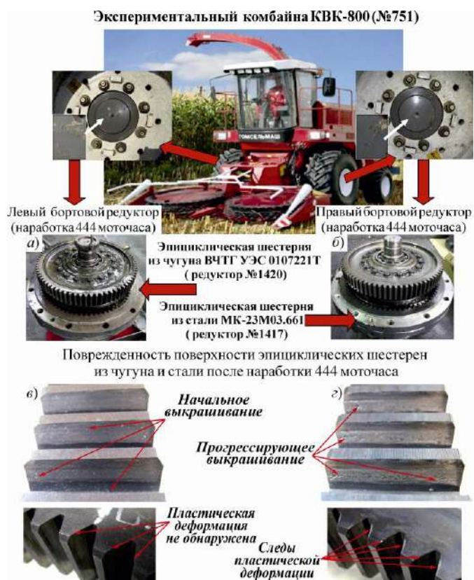
Рисунок 1 – Общий вид комбайна КВК 800 (№ 751) в условиях эксплуатации и эксплуатационные повреждения зубьев эпицикла из чугуна марки ВЧТГ (а, в) и стали (б, г)
