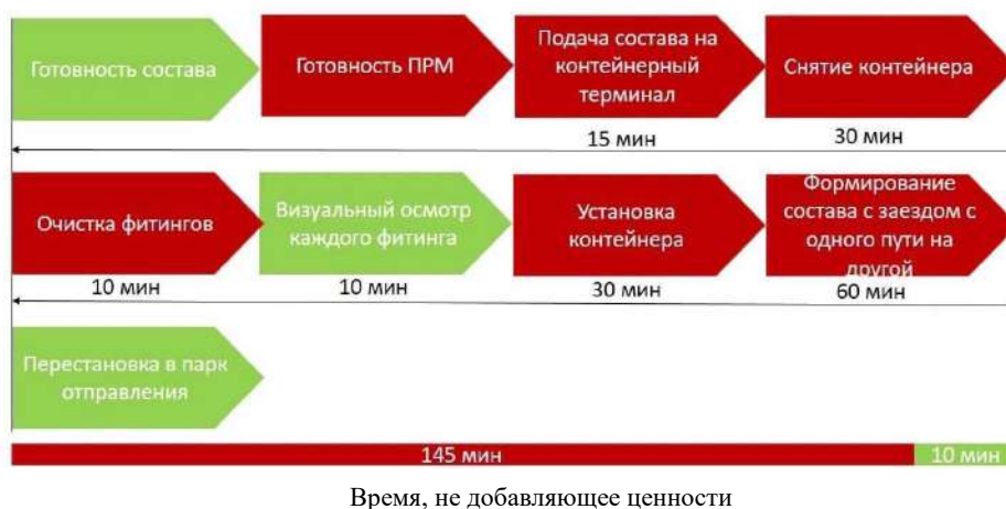
Рисунок 1 – Технологическая карта осмотра фитинговых упоров вагонов-платформ по существующей технологии (в порожнем состоянии)
