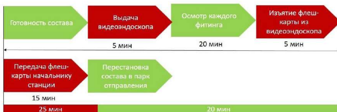
Рисунок 2 – Технологическая карта осмотра фитинговых упоров вагонов-платформ по предлагаемой технологии (в груженом состоянии)
