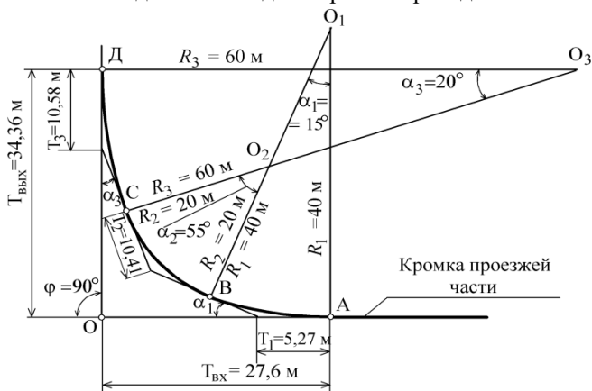
Рисунок 3.23 – Разбивка сопряжения кромки проезжей части
