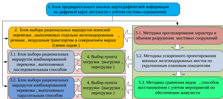
Рисунок 2 – Укрупненная схема методики поиска рационального маршрута выполнения воинской перевозки в условиях воздействия противника на мостовые сооружения с использованием цифровой карты местности
