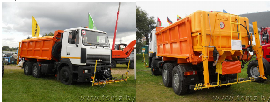
Рисунок 1 – Оборудование высокого давления с распределителем жидких материалов OPC-37 на базе автомобиля МАЗ-6501
