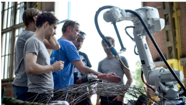
Рисунок 3 – Распечатка экспериментальной конструкции из металла
