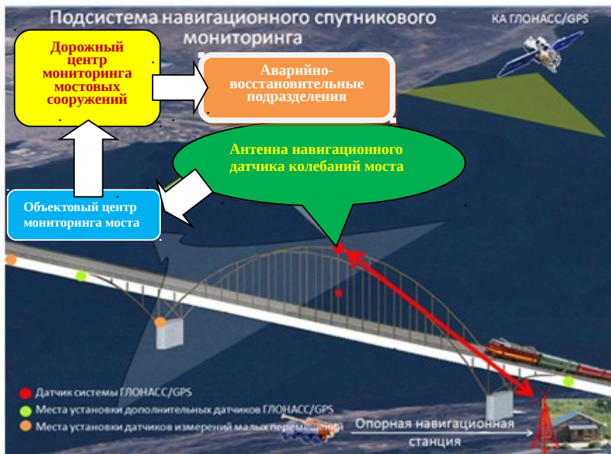
Рисунок 1 – Подсистема спутникового мониторинга моста
