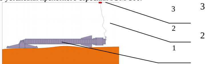
Рисунок 1 – Схема установки плоских опор РЭМ-500 в подготовительный период
