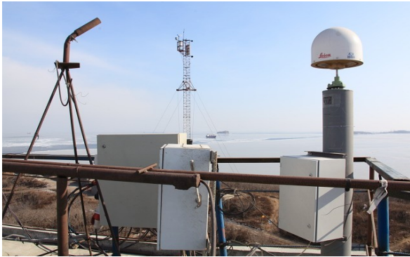
Рисунок 2 – Аппаратура спутниковой системы мониторинга моста
