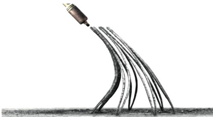
Рисунок 4 – Создание аппаратом MX3D прочных металлических прутков из капель расплавленного металла
