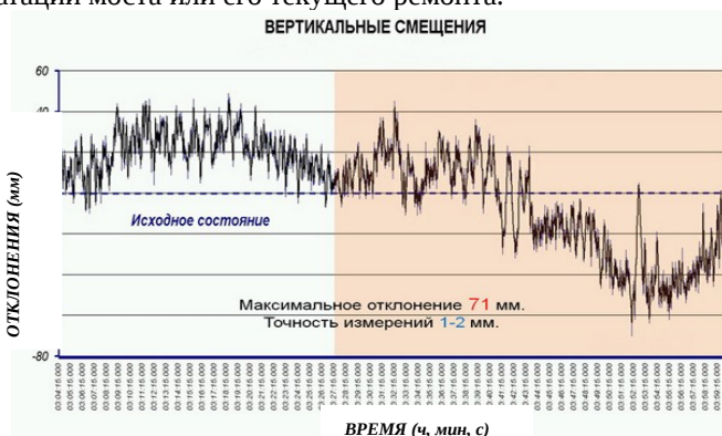
Рисунок 4 – Вертикальные смещения моста от сильных порывов ветра и движения поездов
