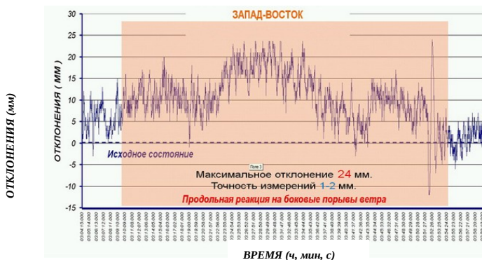
Рисунок 5 – Горизонтальные смещения моста от сильных порывов ветра и движения поездов
