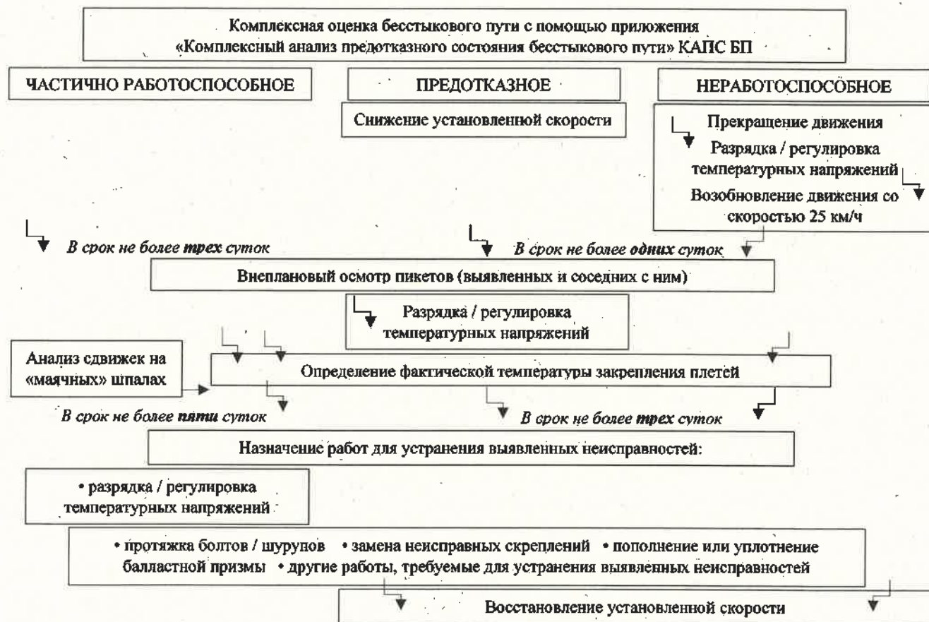
Рисунок 3 – Структура проведения мероприятий, направленных на возобновление работоспособности бесстыкового пути
