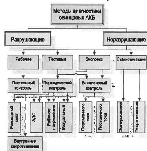
Рисунок 1 – Методы диагностики АКБ
