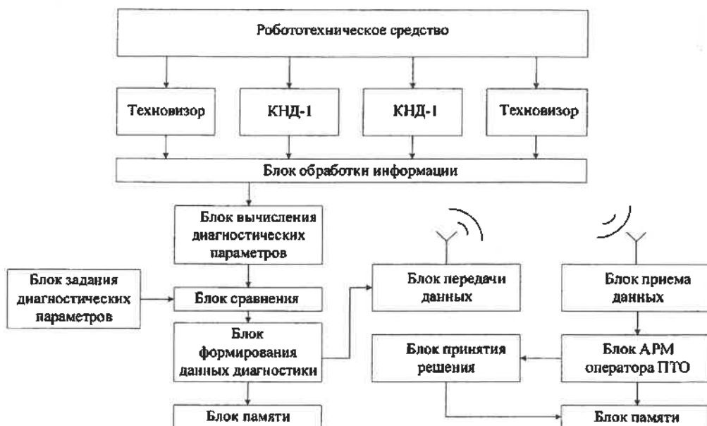
Рисунок 1 – Функциональная схема робототехнического средства для контроля технического состояния грузовых вагонов
