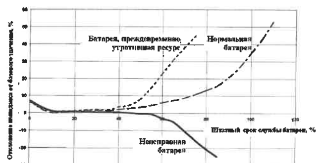
Рисунок 2 – Изменение внутреннего сопротивления АКБ в зависимости от срока службы
