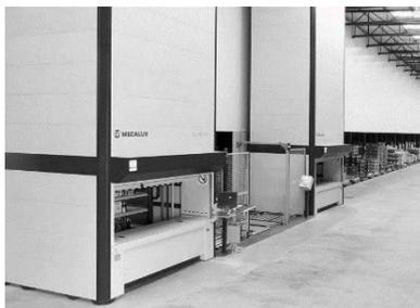
Рисунок 2.8 – Автоматизированные системы хранения и поиска:
