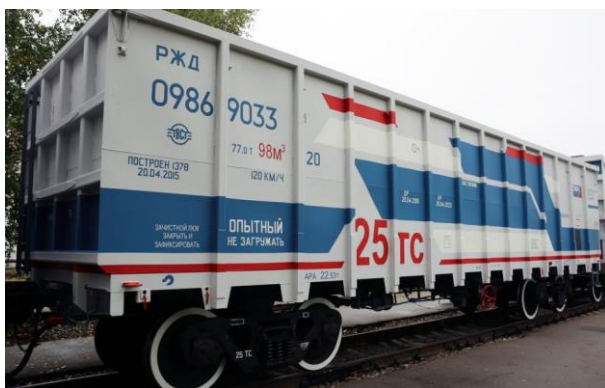
Рисунок 2.29 – Полувагон с глухим кузовом модели 12-9869
