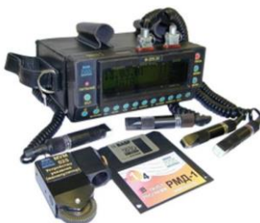
Рисунок 7.3 – Внешний вид феррозондового дефектоскопа ДФ-205
