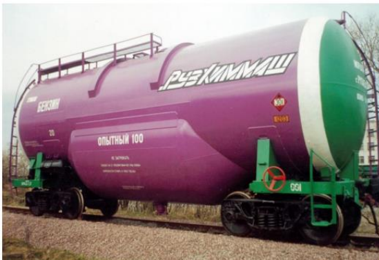
Рисунок 2.47 – Цистерна нового поколения для светлых нефтепродуктов
