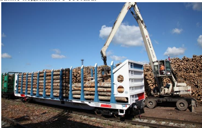
Рисунок 2.36 – Лесовоз нового поколения модели 13-6895
