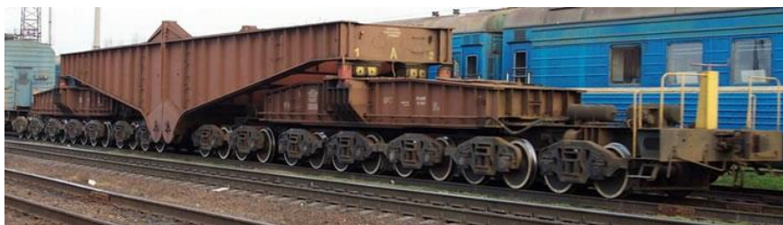
Рисунок 2.40 – Общий вид транспортёра сочлененного типа, модель 14-T003 тип 3996
