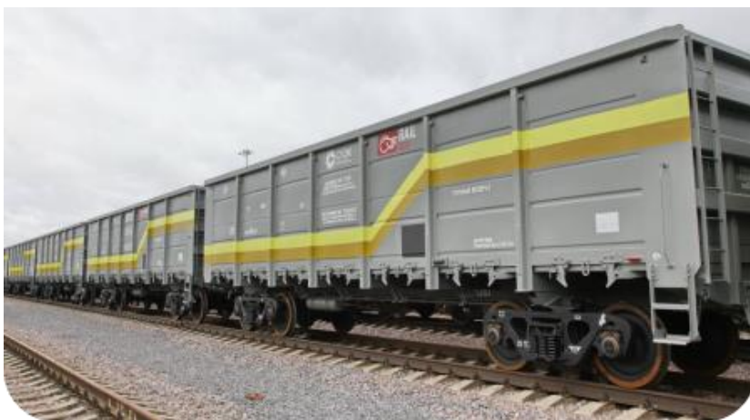
Рисунок 2.24 – Универсальный полувагон модели 12-9853
