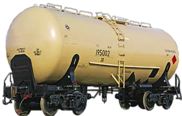
Рисунок 2.45 – Цистерна безрамной конструкции для светлых нефтепродуктов модели 15-195
