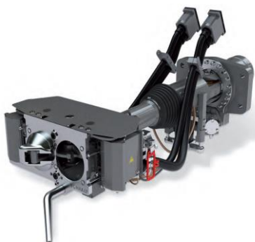
Рисунок 5.16 – Автоматическая сцепка Scharfenberg типа 10 с боковым расположением электрических разъемов
