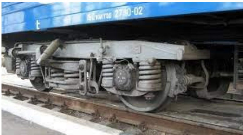
Рисунок 4.13 – Общий вид тележки пассажирского вагона модели 68-875
