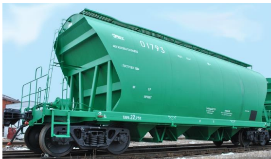
Рисунок 2.18 – Вагон модели 19-9774 для перевозки минеральных удобрений
