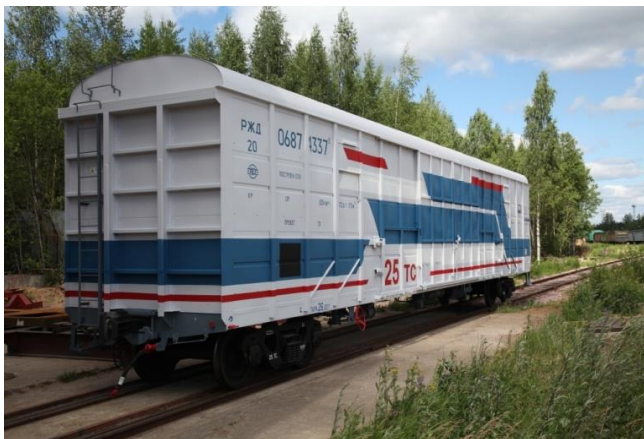
Рисунок 2.7 – Универсальный крытый вагон модели 11-6874
