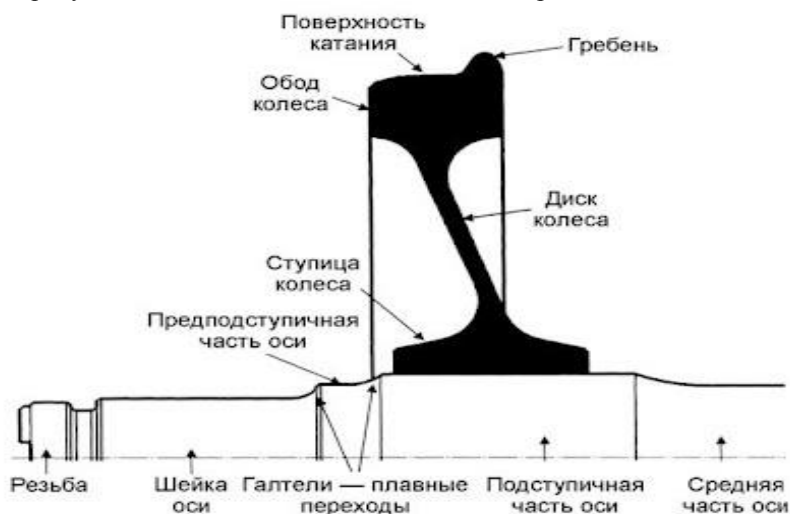
Рисунок 4.2 – Элементы колесной пары
