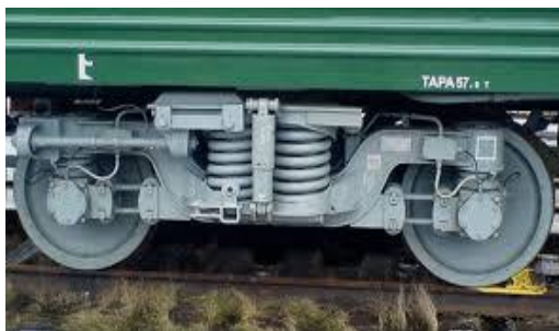
Рисунок 4.19 – Общий вид тележки пассажирского вагона модели 18-4095
