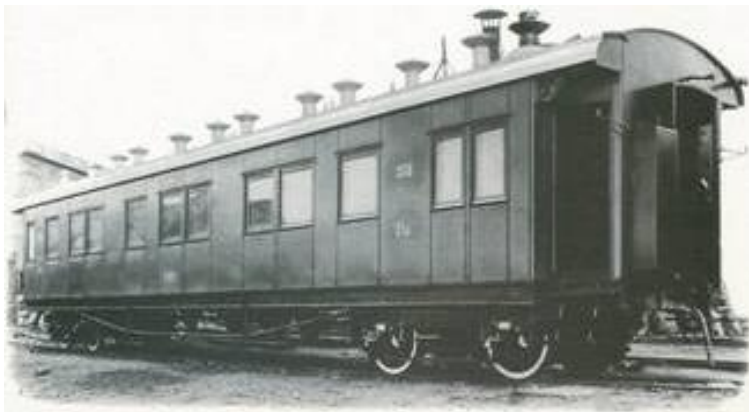
Рисунок 1.6 – Пассажирский 4-осный вагон I класса
