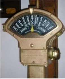
Abbildung 19 – Maschinentelegraph von Siemens
