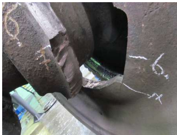
Рисунок 2 – Напряженно-деформированное состояние колеса и фрагмент излома колесного центра
