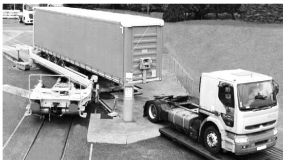
Рисунок 3.20 – Открывание под углом грузовых секций вагонной платформы LOHR UIC
