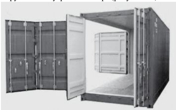
Рисунок 3.4 – Контейнер типа Open Side с боковыми открывающимися дверями
