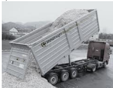
Рисунок 3.5 – Контейнер открытого типа с верхней загрузкой для сыпучих грузов с выгрузкой через торцевую дверь под действием силы тяжести:
