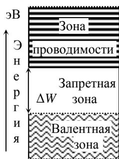
Рисунок 1.4 – Запретная зона на энергетической диаграмме полупроводников и диэлектриков
