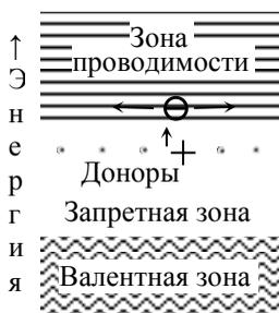
Рисунок 3.5 – Энергетическая диаграмма примесного полупроводника *n*-типа
