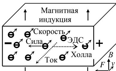
Рисунок 3.2 – Магниторезистивный эффект и поперечная ЭДС Холла
