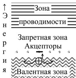
Рисунок 3.4 – Энергетическая диаграмма примесного полупроводника *p*-типа
