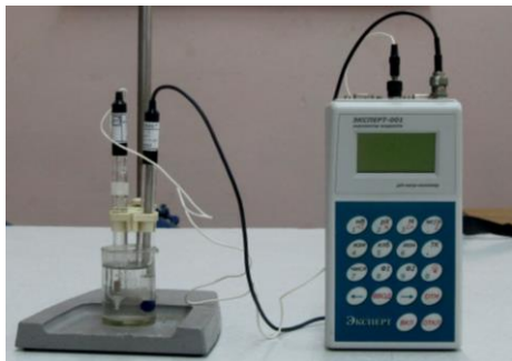
Рисунок 1 – Исследование образца цементно-песчаной фракции анализатором жидкости «ЭКСПЕРТ-001-1»
