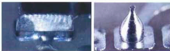
Рисунок 4.153 – Отсутствие смачивания припоем
