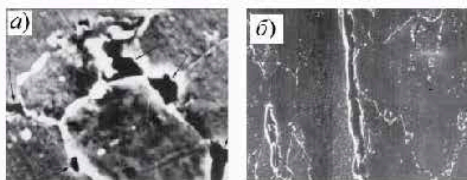
Рисунок 5.3 – Форма пор ползучести (а) (обозначены стрелками, \times 3500 ) и трещины ползучести (б) ( \times 25000 ) в сварном соединении
