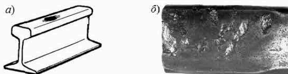
Рисунок 6.4 – Схематическое изображение дефекта 14.1-2 (а) и его вид (б)
