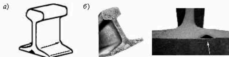
Рисунок 6.38 – Схематическое изображение дефекта 79.1-2 (а) и его вид (дефект 79.2/69.2) (б)
