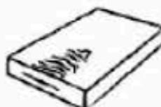
Рисунок 4.48 – Раскатанная (раскованная) трещина
