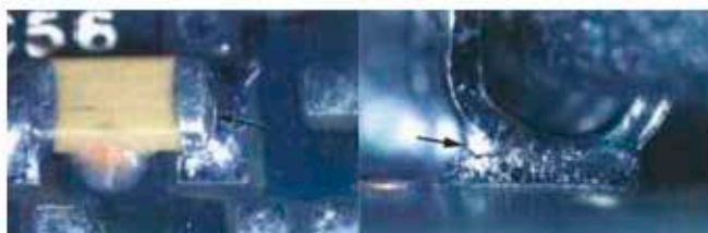
Рисунок 4.155 – Трещины в паяных соединениях [18]
