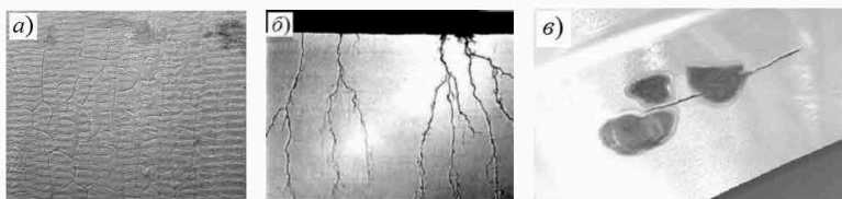
Рисунок 5.4 – Дефекты, образовавшиеся в результате термических воздействий: трещины термической (а), химической (б) усталости; растрескивание под действием термических напряжений (в)
