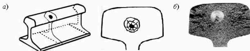
Рисунок 6.8 – Схематическое изображение дефекта 20.1-2 (а) и его вид (б).
