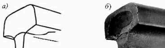
Рисунок 6.15 – Схематическое изображение дефекта 33.1 (а) и его вид (б)
