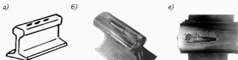
Рисунок 6.1 – Схематическое изображение дефекта 10.1-2 (а) и его вид (б, в)
