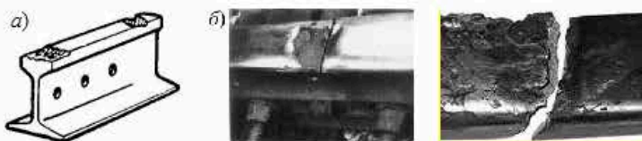
Рисунок 6.6 – Схематическое изображение дефекта 18.1-2 (а) и его вид (б)
