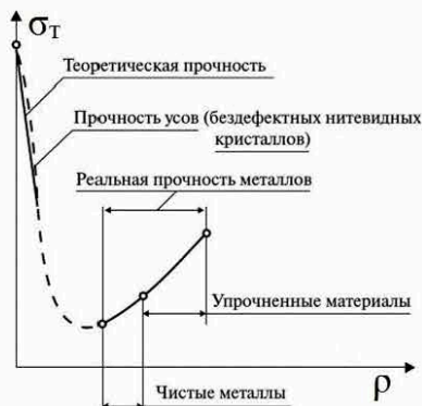
Рисунок 3.5 – Зависимость предела текучести \sigma_t от плотности дислокаций \rho
