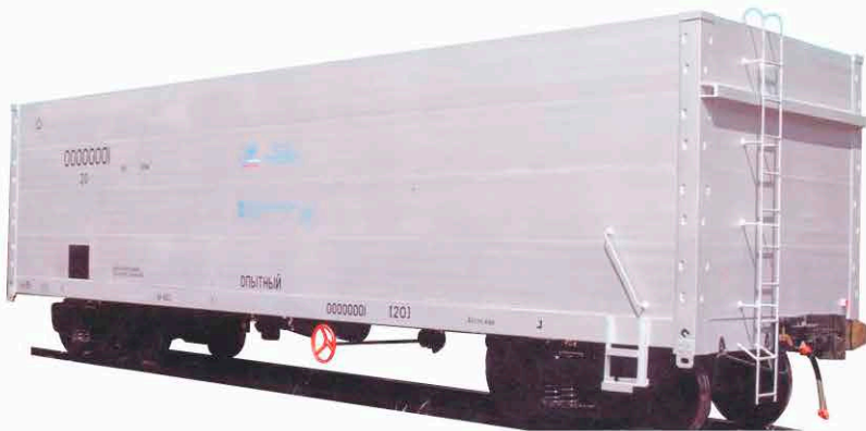
Рисунок 1.95 – Четырехосный полувагон с глухим кузовом из алюминиевых сплавов модели BA2005
