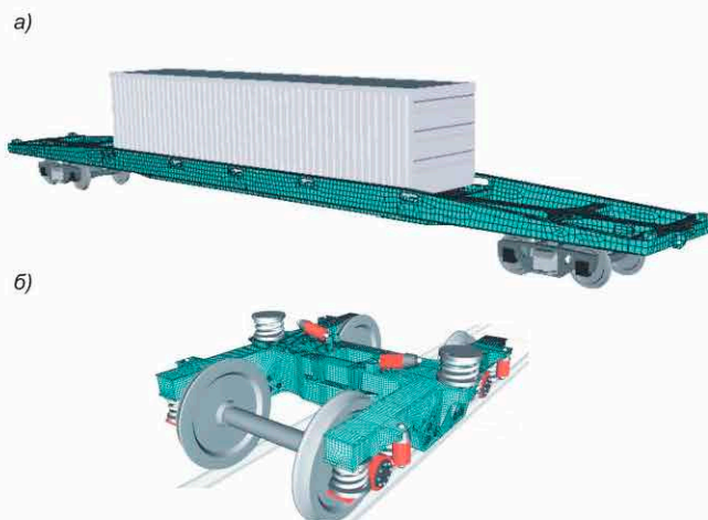
Рисунок 5.10 – Гибридные модели с упругой конечно-элементной рамой: а – платформа для перевозки крупнотоннажных контейнеров; б – тележка пассажирского вагона
