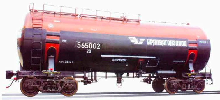
Рисунок 1.271 – Вагон-цистерна модели 15-565 для вязких нефтепродуктов Техническая характеристика безрамных цистерн приведена в таблице 1.18.
