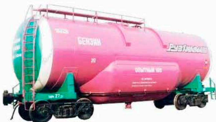
Рисунок 1.272 – Вагон-цистерна нового поколения с котлом переменного сечения
