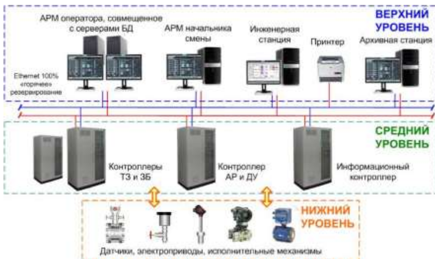
Рисунок 2.6 – Блок-схема аппаратного комплекса АСУ предприятия «Водоканал», обеспечивающая работоспособность модели единого информационного пространства
