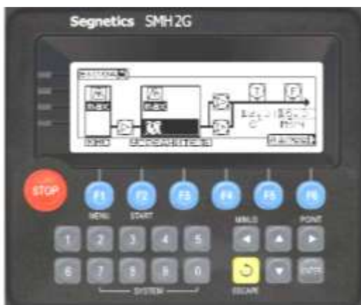
Рисунок 9.2 – Внешняя панель контроллера «Segnetics» российского производства
