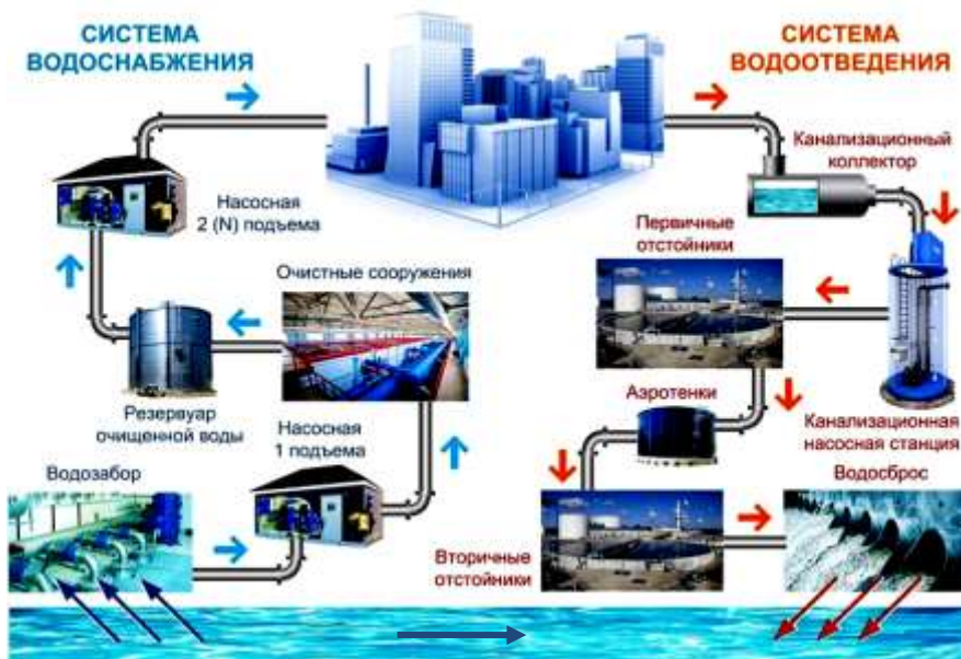
Рисунок 2.1 – Принципиальная схема централизованного водоснабжения и водоотведения потребителей ( https://pbs.twimg.com/media/EW2mabxWoAAw-nO.jpg )
