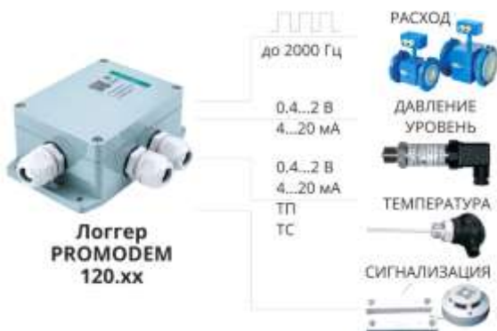
Рисунок 6.10 – Подключение расходомеров и датчиков к внешним входам логгера
