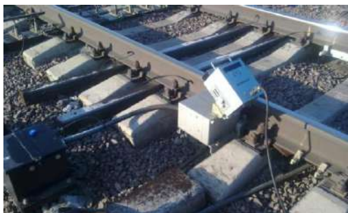
Рисунок 1 – Автоматический прибор для обнаружения нагретых букс
