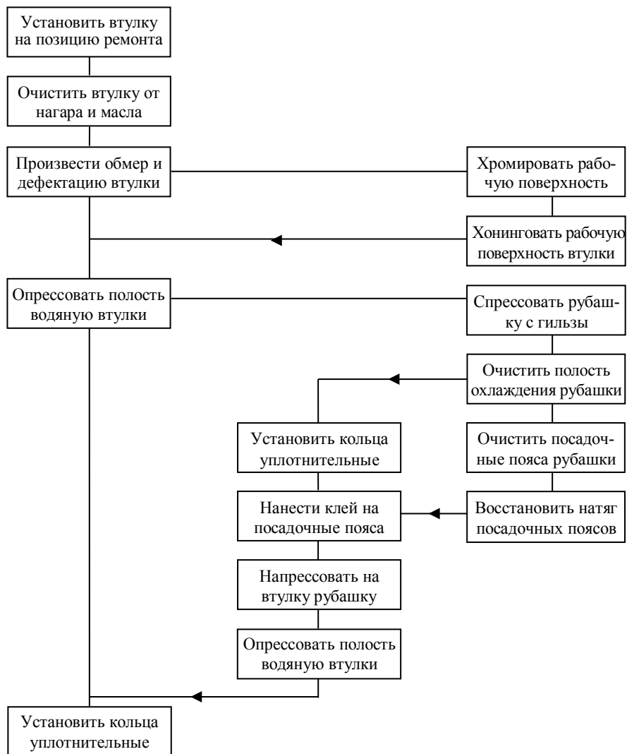
Рисунок 4.2 – Структурная схема процесса ремонта цилиндровой втулки
