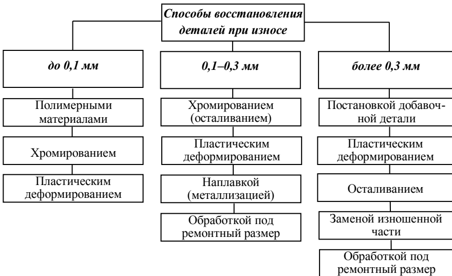
Рисунок 3.1 – Классификация способов восстановления деталей
