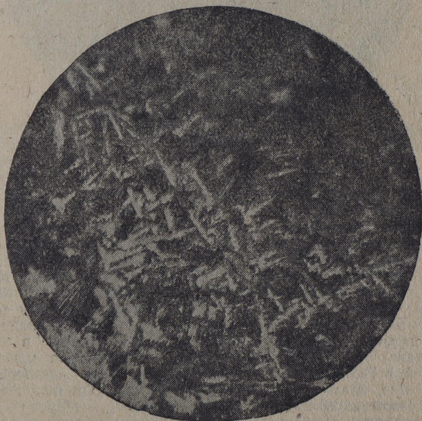
Рис. 3. Микрошлиф искусственного базальта
