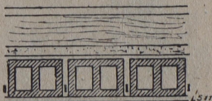
Рис. 51. Перекрытие из потолочного кирпича Клейне. Поперечный разрез
